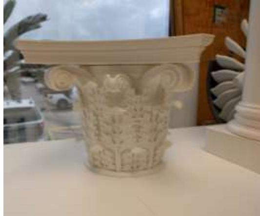
صورة (26) تاج العمود - من أصعب الأجزاء التي تم طباعتها هي الجزء العلوي من العمود نظراً لتفاصيله الدقيقة
