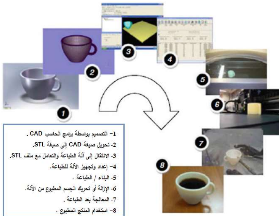
شكل ( 7 ) يوضح خطوات أو مراحل عملية الطباعة ثلاثية الأبعاد
